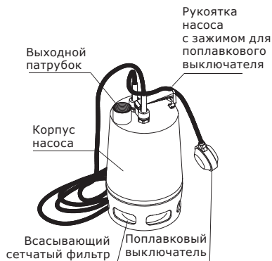
Рис. 1 Конструкция насосов APV.06 / APV.40 V
